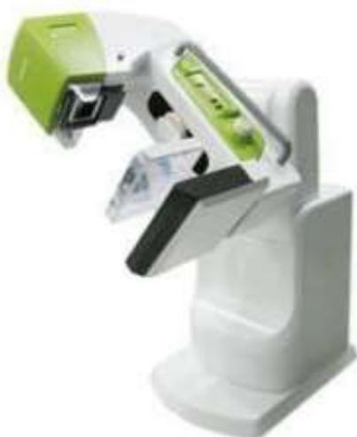
EXR-650 — надёжный маммограф, обладающий прецизионной системой настроек и высокой производительностью. Для получения изображения используется цифровой приемник рентгеновского излучения прямого преобразования на основе a-Se (аморфного селена), который напрямую преобразует рентгеновское излучение непосредственно в электронный сигнал. Мгновенное получение изображения сокращает время на проведение исследований и делает цифровую маммографию оптимальным инструментом для диагностики.
